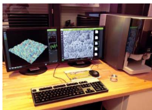
Фиг. 21: Сканиращ електронен микроскоп Phenom proX.
