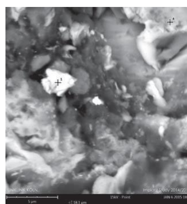
Фигура 33: Детайлно изображение (x10 000) при EDX спот анализ (вляво: метални частици, вдясно: контрол)
