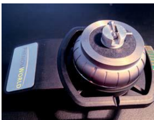
Фигура 22: Устройство за поставяне на мостри за наблюдение със СЕМ с поставен имплант
